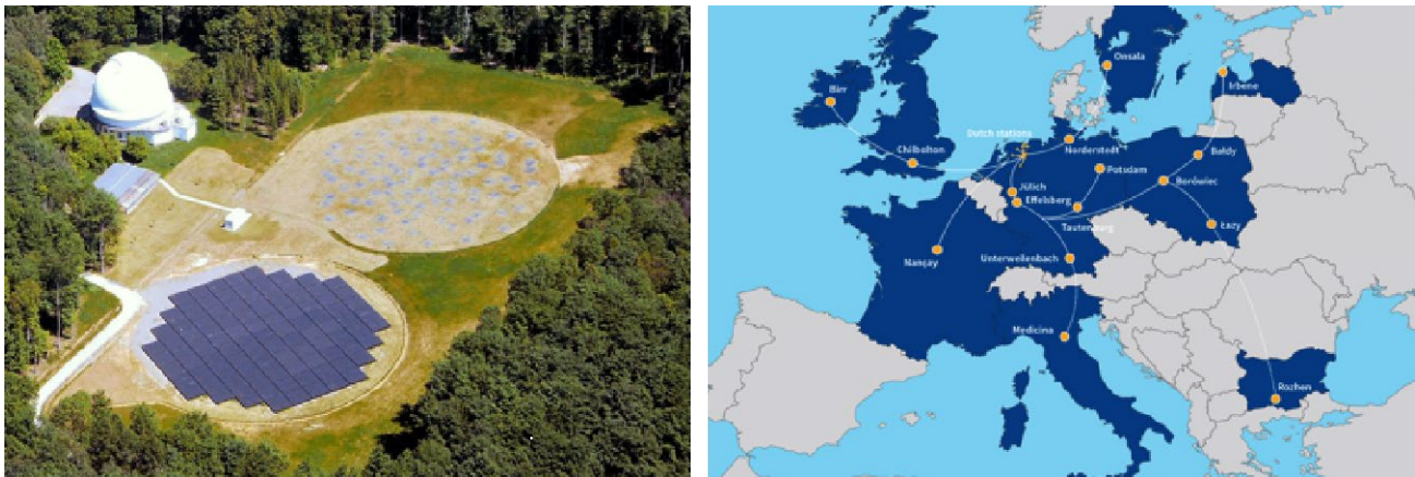
Abb. 8 (links): Die LOFAR-Station des TLS befindet sich südlich der 2-m-Teleskopkuppel. Die Low-Band-Antennen befinden sich oben, die High-Band-Antennen darunter (Foto: M. Pluto). (rechts) Karte des internationalen LOFAR-Radioteleskops mit Stationen in ganz Europa. Die TLS-Station war die zweite internationale Station, die in Betrieb genommen wurde.
