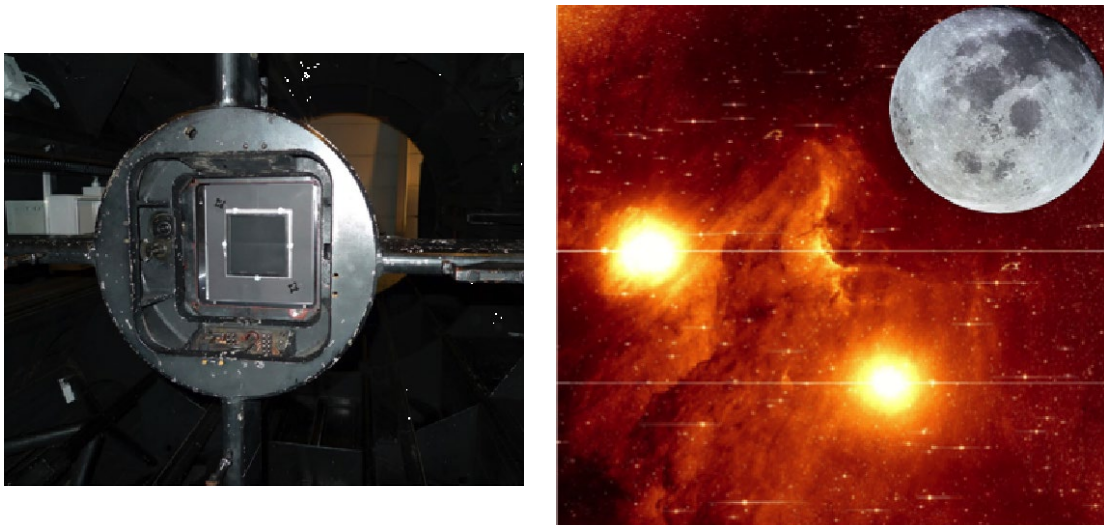
Abb. 2 (links): TAUkam im Schmidt-Fokus. Das Quadrat in der Mitte ist der CCD-Detektor. (rechts) Bild des Pelikannebels, aufgenommen mit TAUkam. Zum Vergleich ist ein Bild des Vollmondes (Foto: NASA) eingeblendet, wie es erscheinen würde, wenn es mit TAUkam beobachtet würde.
